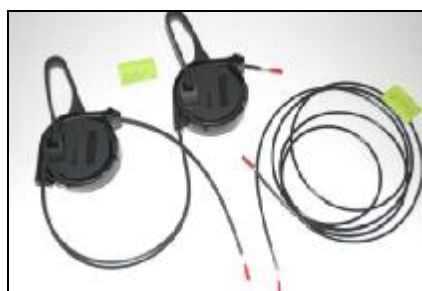
testované drop kabely s kotvou @
